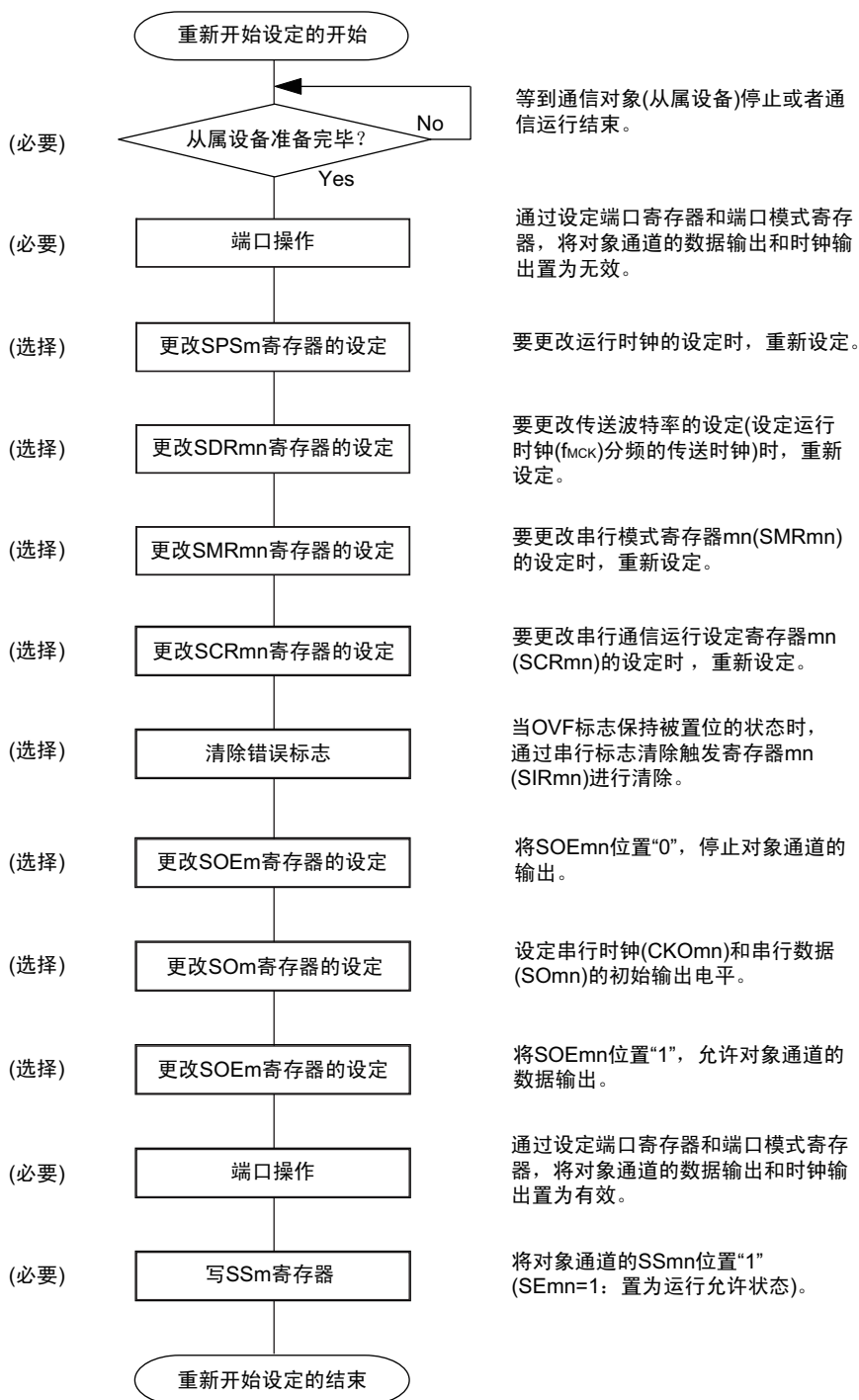
图 12-41 主控发送和接收的重新开始设定步骤
