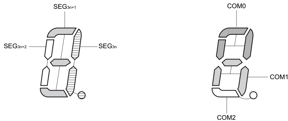
图 13-33 3 个时间片的 LCD 显示图形和电极连线
