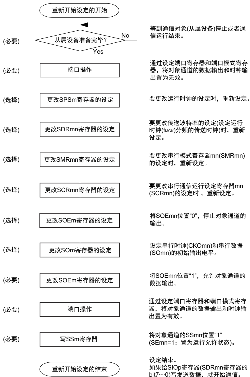
图 12-25 主控发送的重新开始设定步骤
