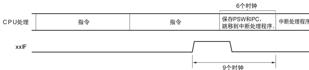
图 14-8 中断请求的接受时序（最短时间）
