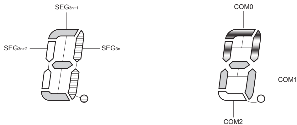
图 17-31 3 个时间片的 LCD 显示图形和电极连线
