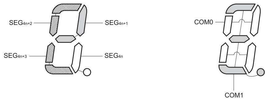
图 17-28 2 个时片的 LCD 显示图形和电极连线
