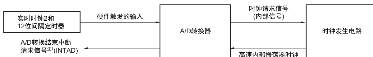
图 12-28 使用 SNOOZE 模式功能时的框图
