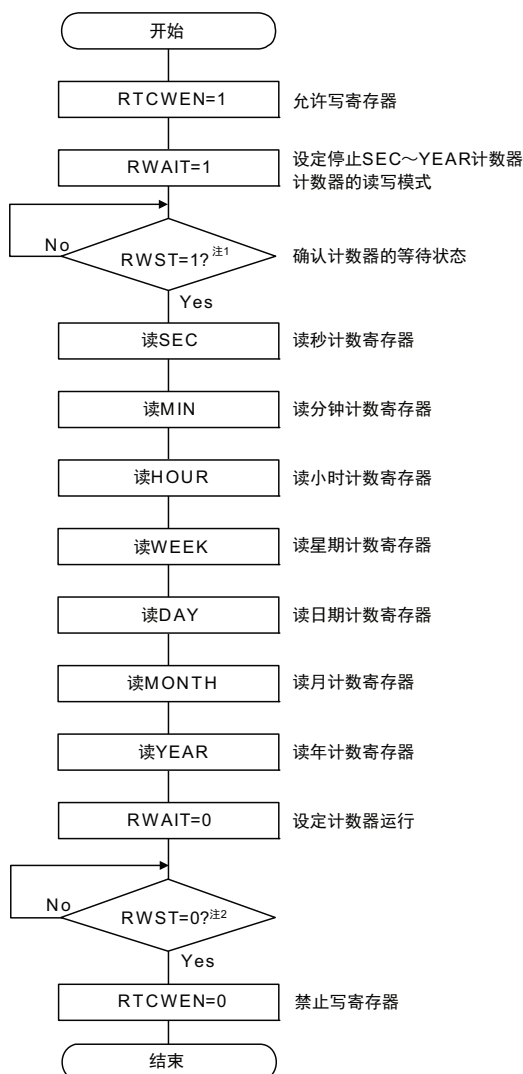
图 7-21 实时时钟 2 的计数器读操作步骤
