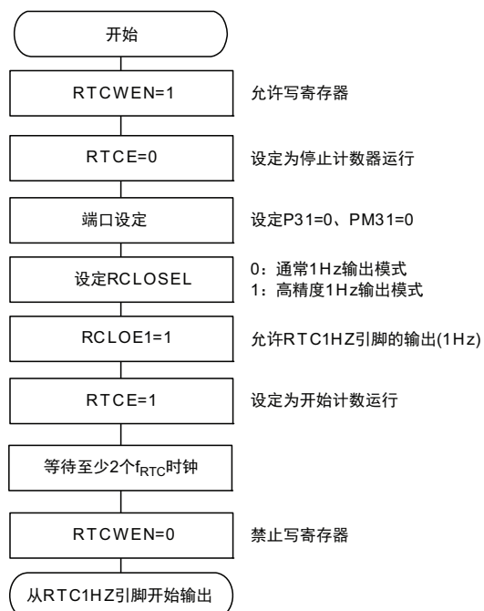
图 7-24 1Hz 输出的设定步骤
