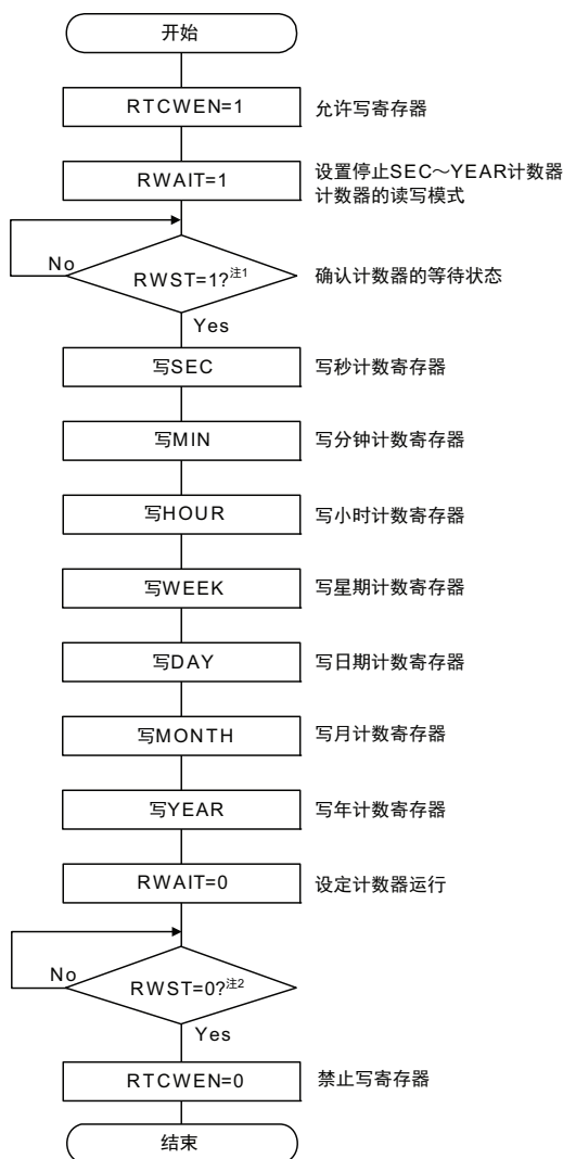
图 7-22 实时时钟 2 的计数器写操作步骤
