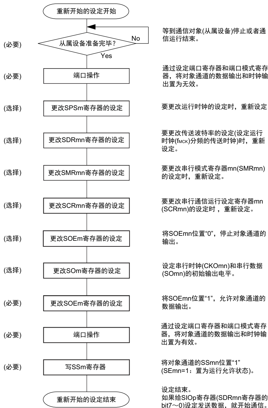
图 14-28 重新开始主控发送的设定步骤
