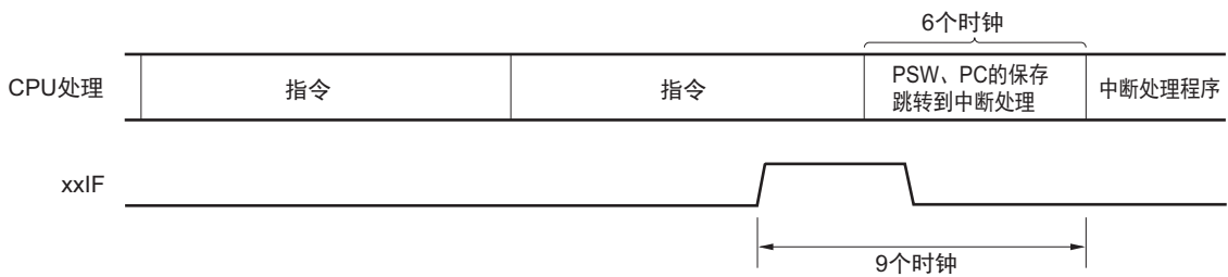
图 20-8 中断请求的接受时序（最短时间）
