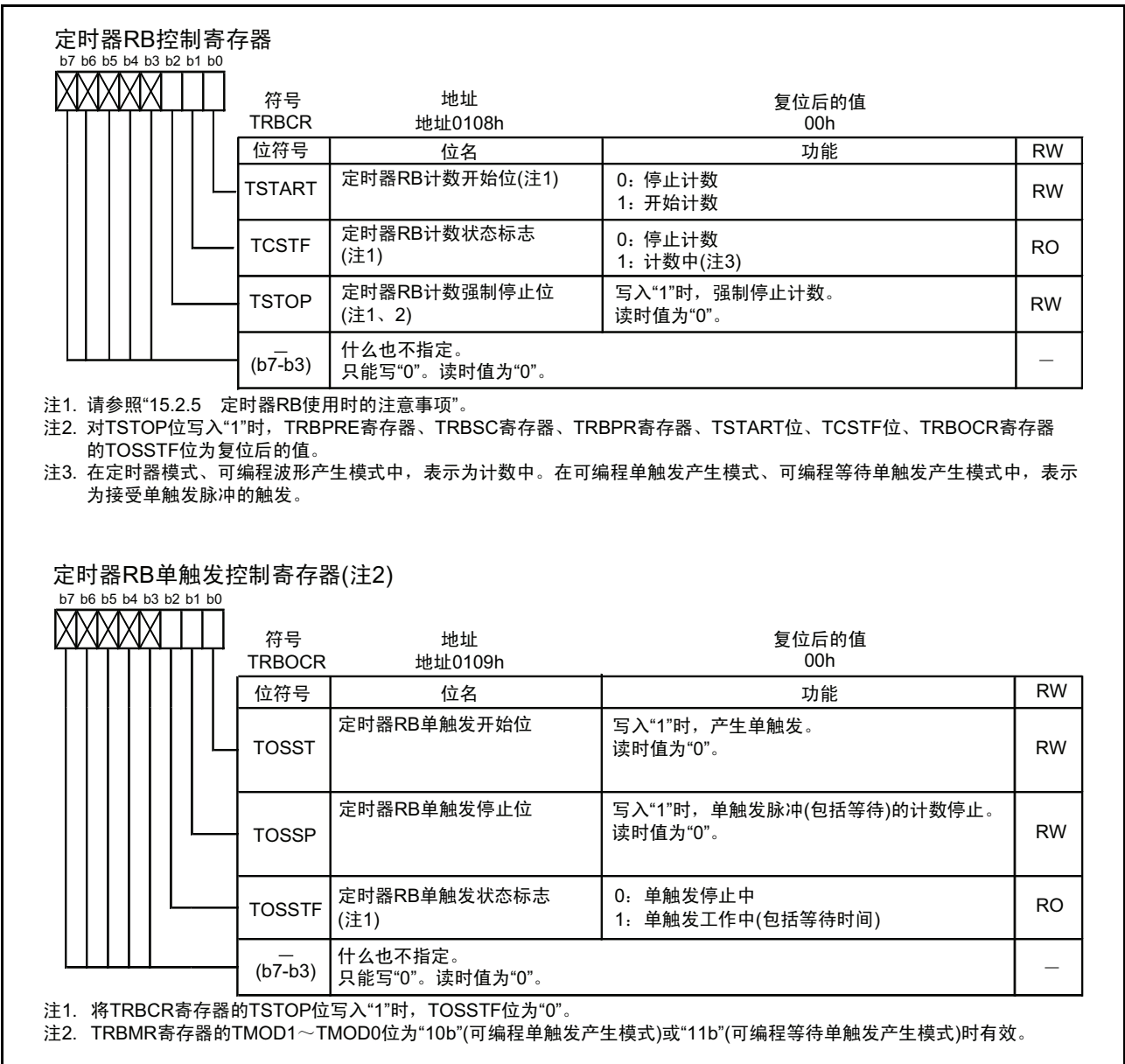
图 15.13 TRBCR、TRBOCR 寄存器
