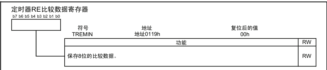
图 15.164 输出比较模式时的 TREMIN 寄存器
