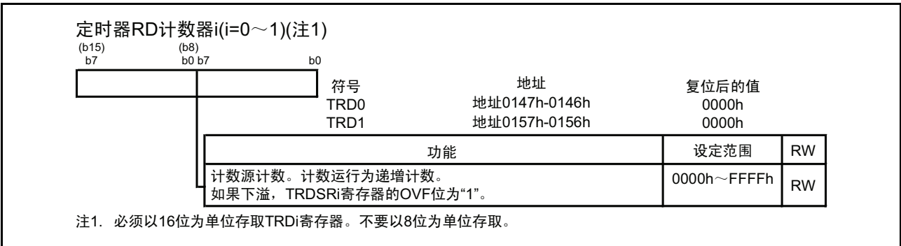
图 15.95 输出比较功能时的 TRD0 ~ TRD1 寄存器
