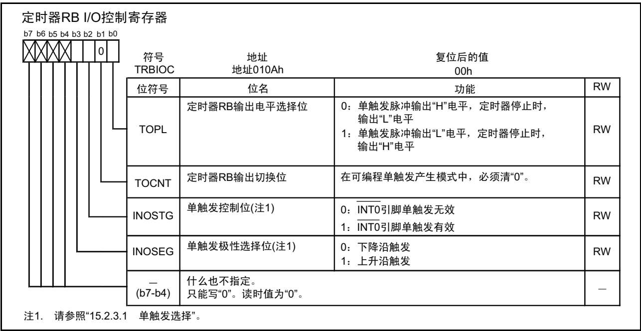
图 15.20 可编程单触发产生模式时的 TRBIOC 寄存器
