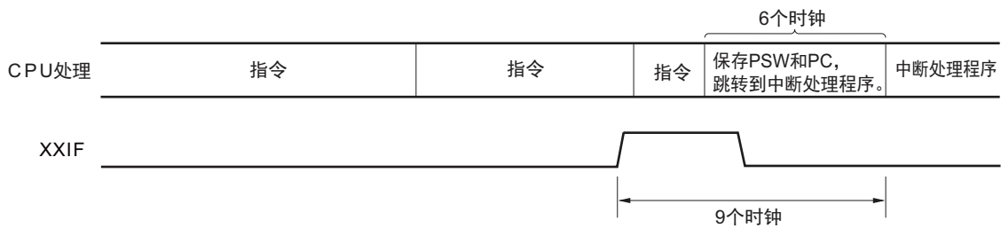
图 16-8 中断请求的接受时序（最短时间）
