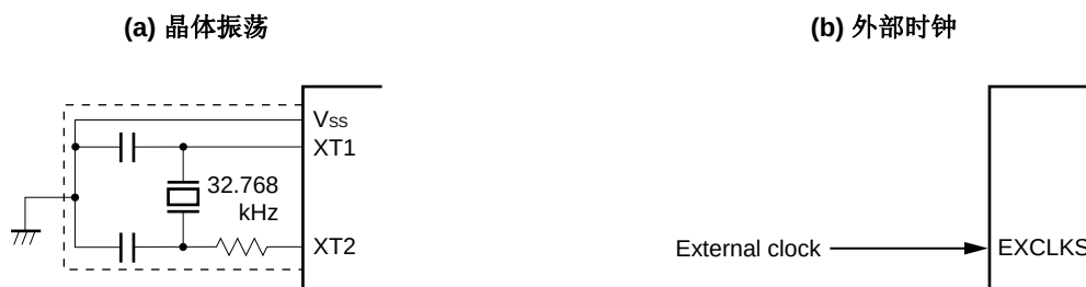
图 5-13. XT1 振荡电路的外接电路示例
