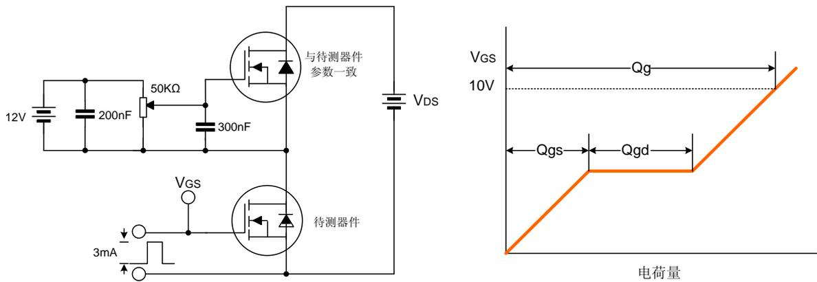
开关时间测试电路及波形图
